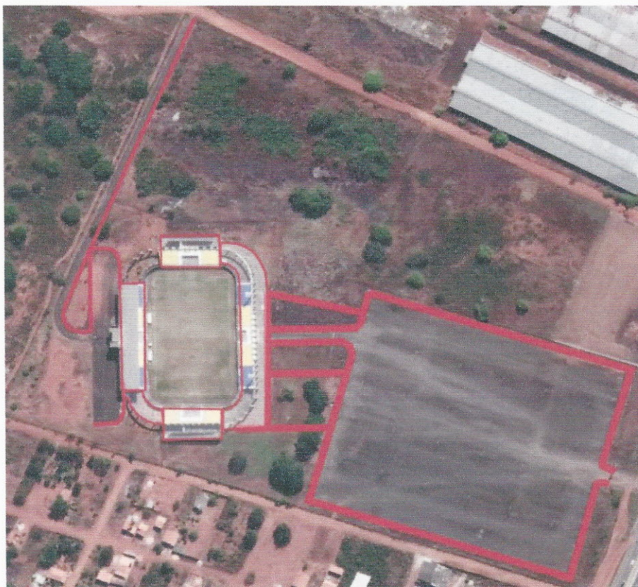
ILUSTRAÇÃO 34 – CALÇADAS EXECUTADAS (2,00mts e 1,00mt)
